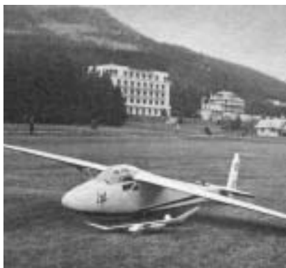
Die 2. Capotvariante der HB-278 verbesserte die Sichtverhältnisse, aber störte die Anströmung des Leitwerks. AeroRevue Nr. 6/1942
